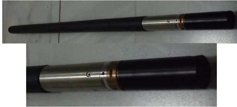
Figura 45: Sonda de medición de radiación Gamma Natural QL40-GRA
