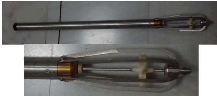
Figura 46: Sonda de medición de flujo (Flowmeter) QL40-SFM.
