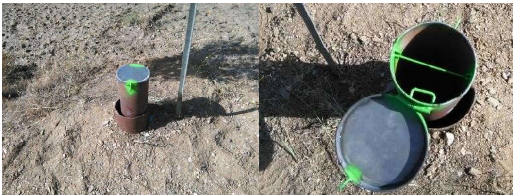
Foto 51: Estado del sondeo 2141/7/0029 tras el acondicionamiento.
