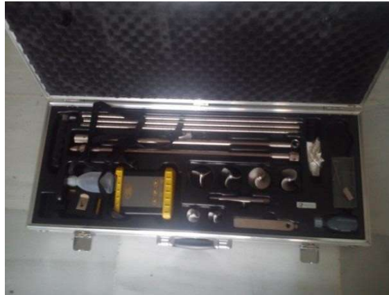
Figura 8: Micromolinete de hélice OTT C-2 y contador OTT Z400.
