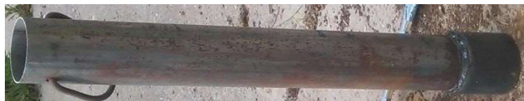
Figura 43: Sonda de inspección preliminar, para la medida de profundidad de sondeos y reconocimiento de la no obstrucción de estos.
