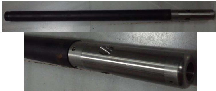
Figura 44: Sonda de conductividad y temperatura del fluido QL40-FTC.
